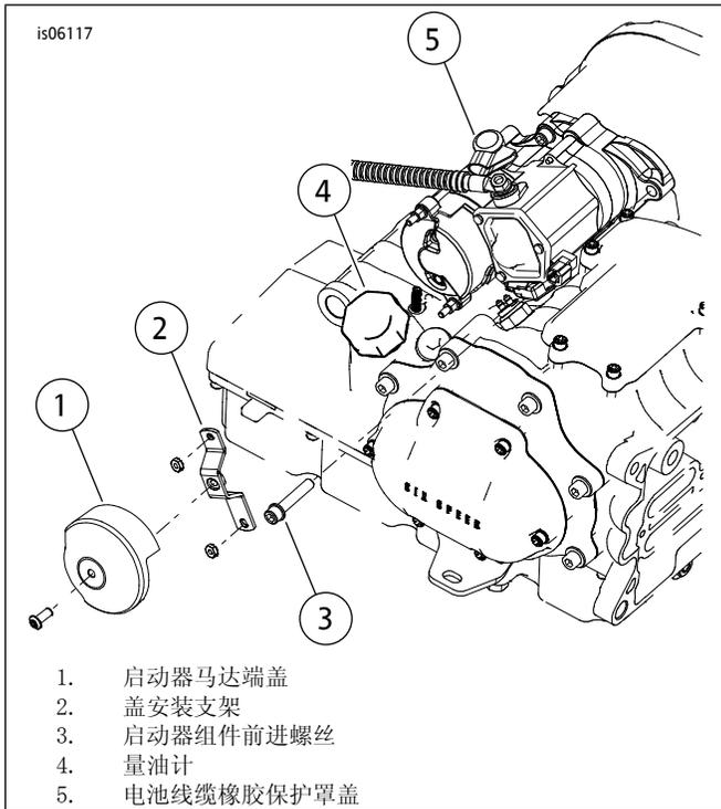
图3。拆卸部件
