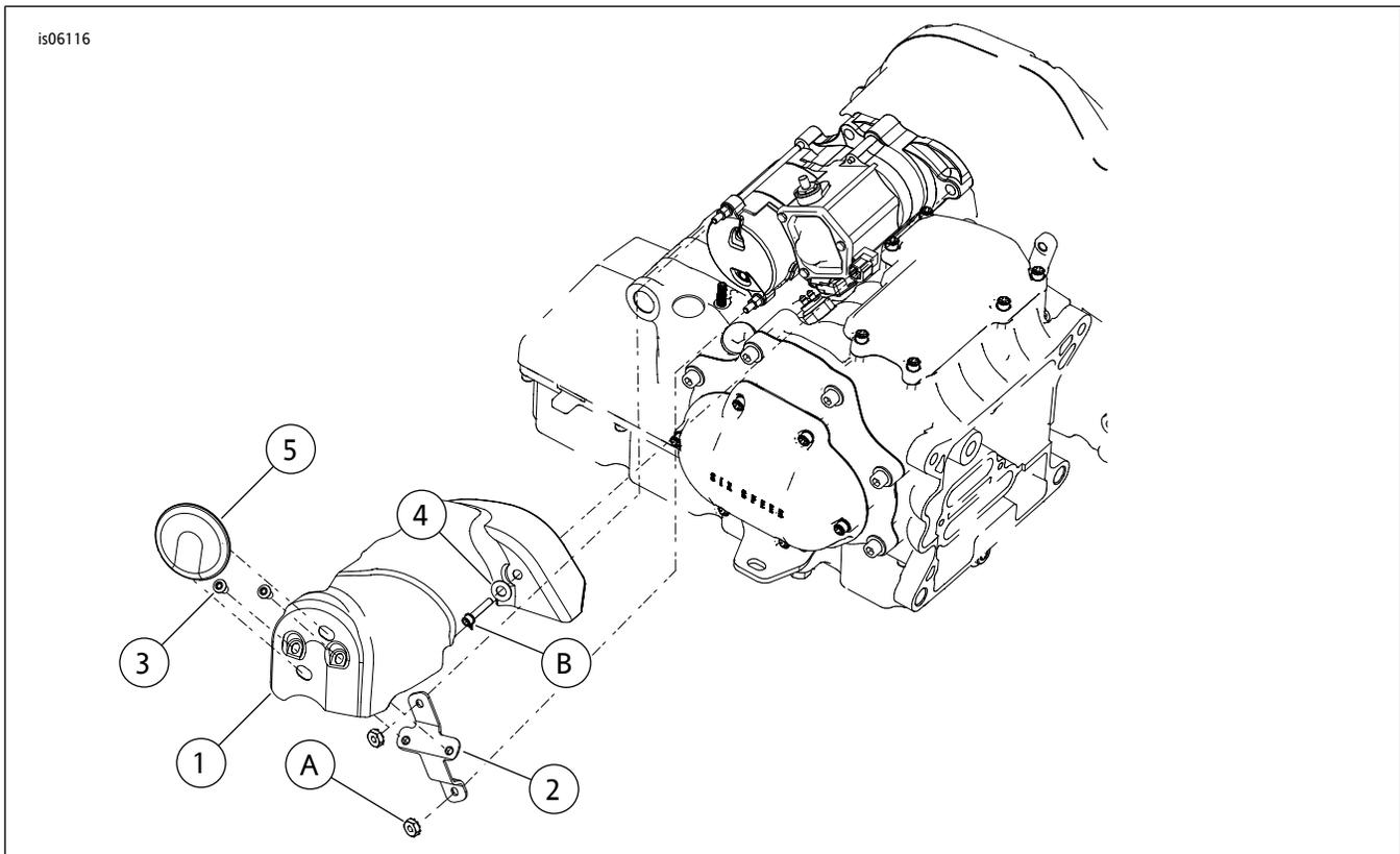
图4。维修零件：Touring启动器盖
