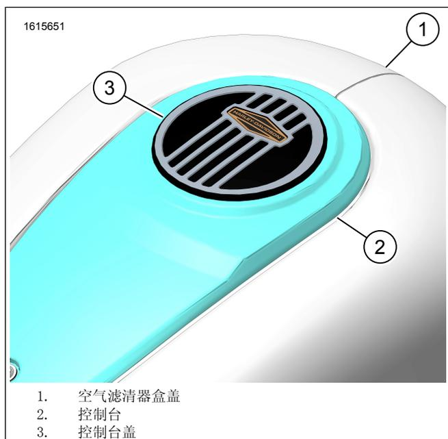
图2。安装的控制台装饰
