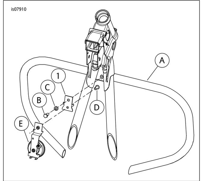
图1。维修零件：喇叭支架适配器套件
