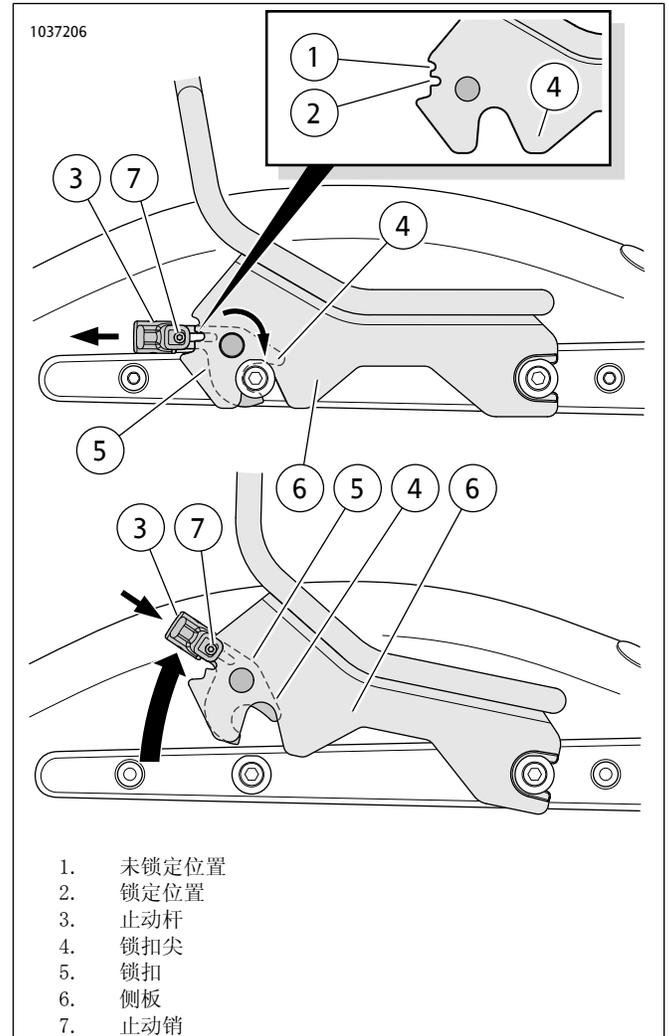
图1。拆卸可拆卸式附件
