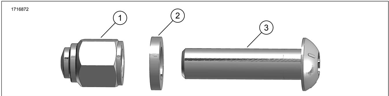
圖1。套件內容：腳樁螺絲工具包
