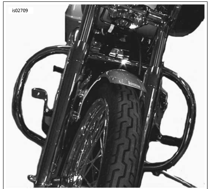
图2。安装发动机护罩
