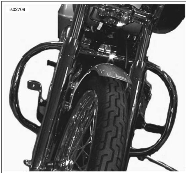
**Figura 2. Protezione del motore installata**
