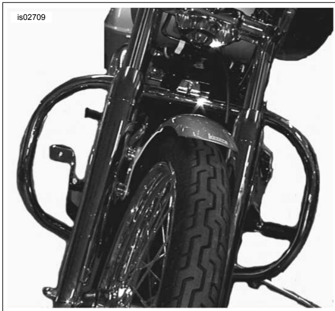
Figura 2. Protetor do motor instalado
