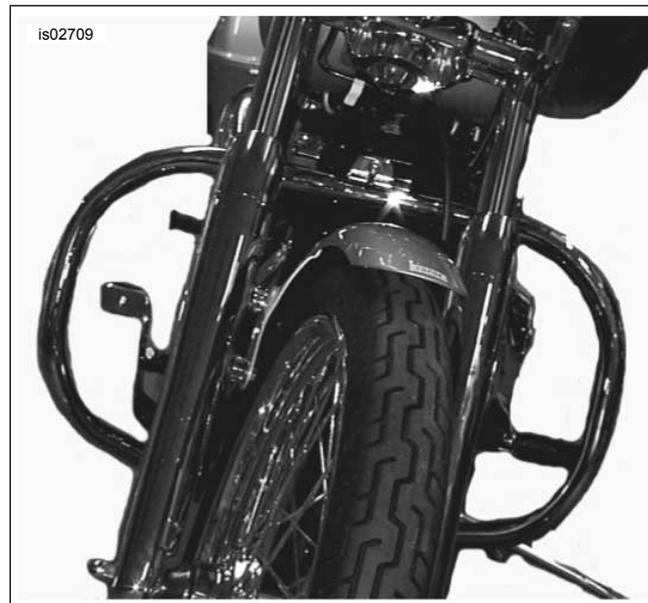
Figura 1. Protetor do motor instalado
