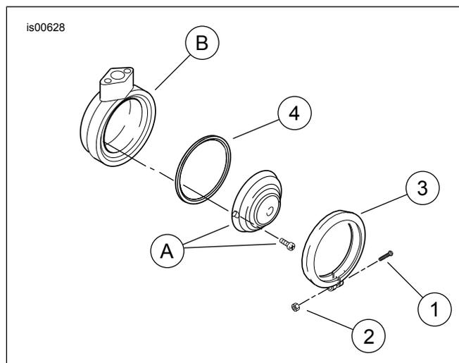
Figura 1. Parti di ricambio: anelli di rivestimento degli indicatori di direzione
