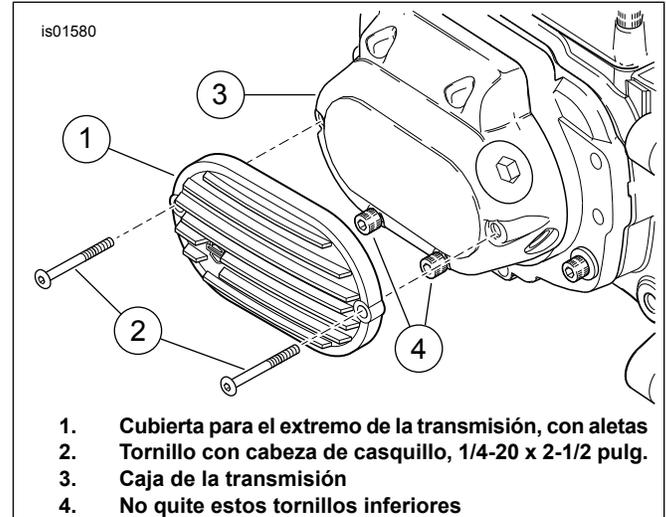
Figura 1. Instalación del extremo de la transmisión
