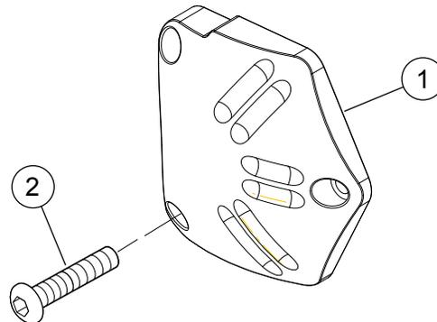
Figura 1. Parti di ricambio: coperchio dell'elettromagnete
