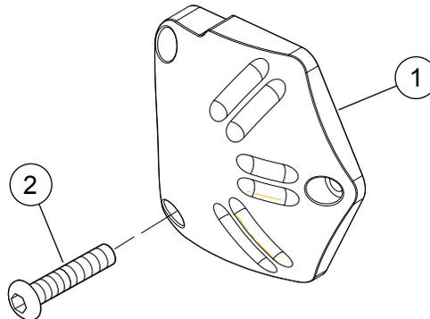
Figura 1. Piezas de servicio: cubierta del solenoide
