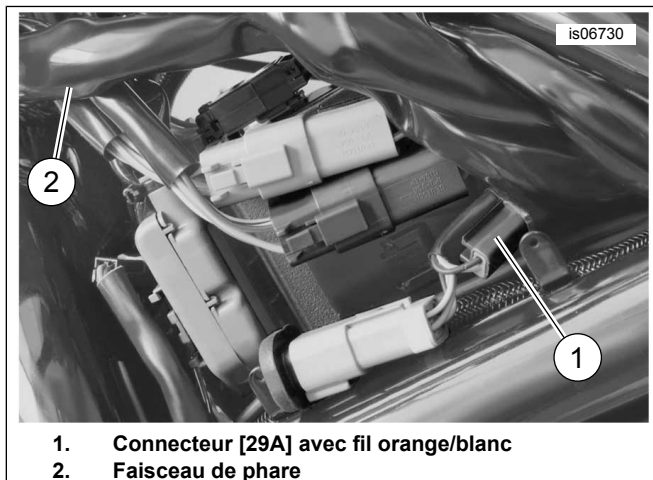
Figure 22. Emplacements des épissures de fil (modèles V-Rod de 2004)
