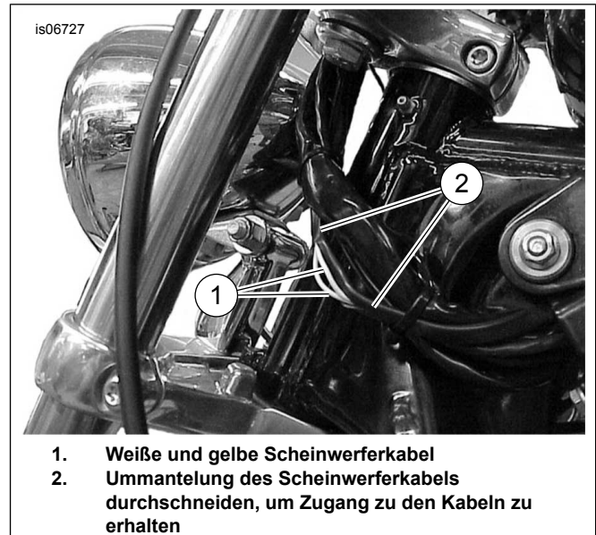
Abbildung 25. Optionale äußere Spleißverbindung des weißen und gelben Kabels (Sportster-Modelle)
