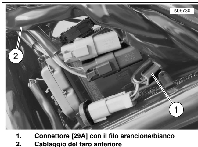
Figura 22. Punti di giunzione dei fili (V-Rod 2004)
