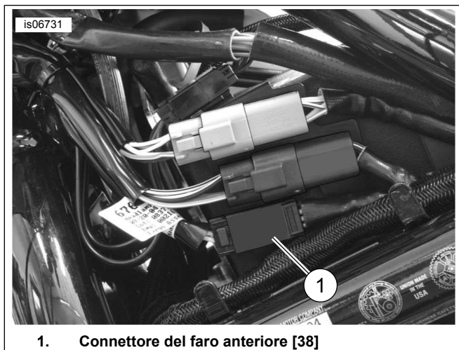
Figura 23. Punti di giunzione dei fili (V-Rod 2005 e anni successivi)
