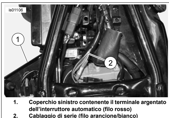
Figura 20. Collegamenti di alimentazione (modelli Sportster)
