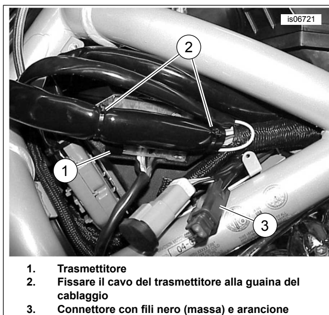
Figura 12. Montaggio del trasmettitore (solo V-Rod 2002-2003)
