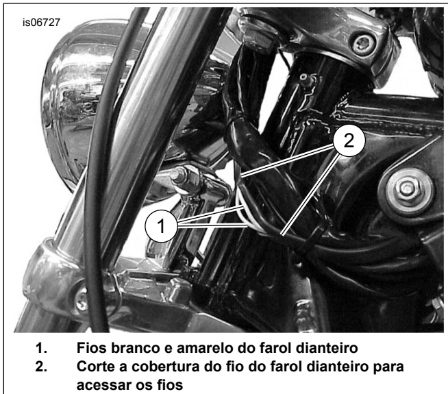
Figura 25. Localização da emenda externa opcional do fio branco e amarelo (Modelos Sportster)
