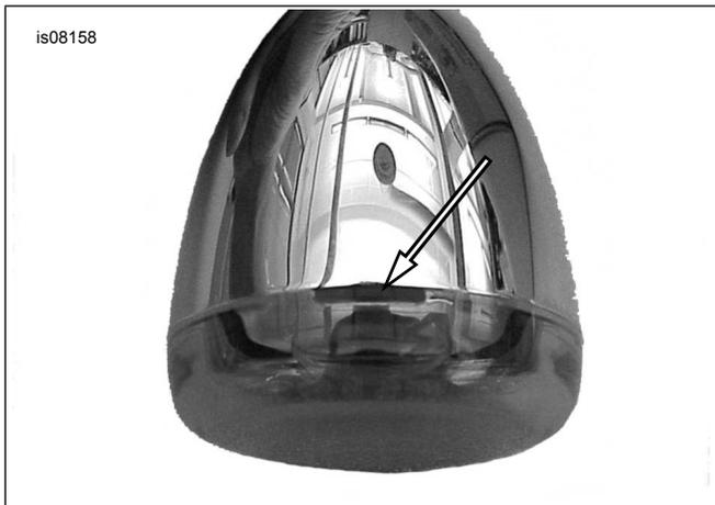
Figure 14. Installation du diffuseur du feu de direction (vue du bas)
