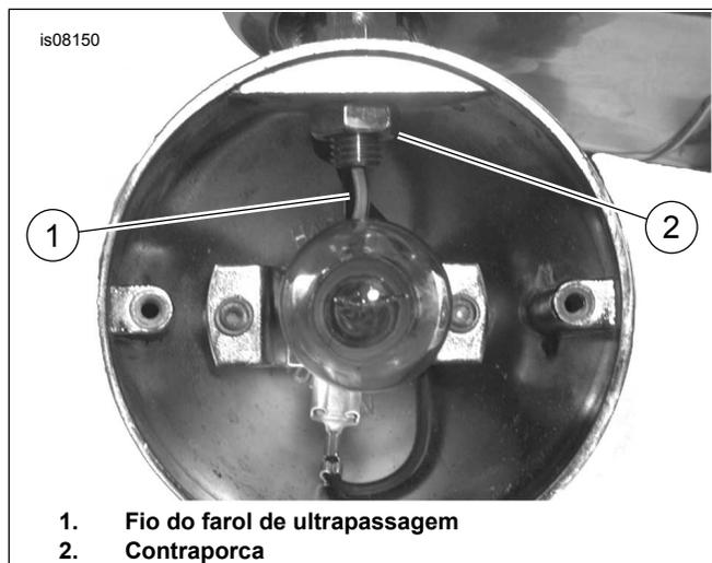
**Figura 6. Instalação da contraporca**
