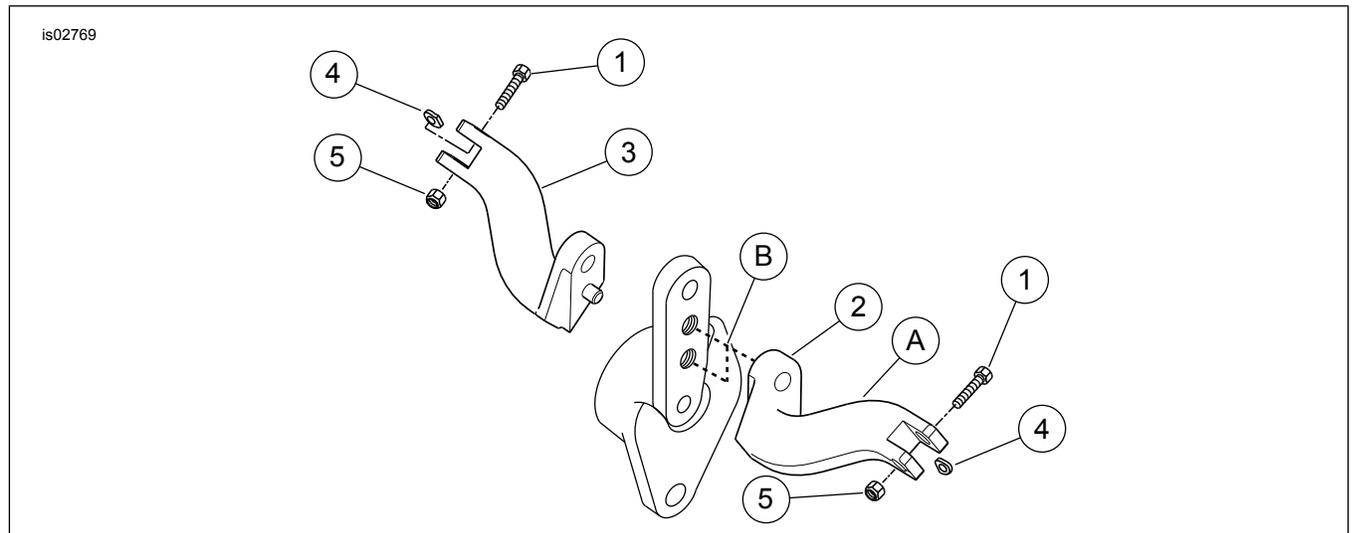
Figura 1. Parti di ricambio: kit di montaggio delle pedaline poggia piedi del passeggero
