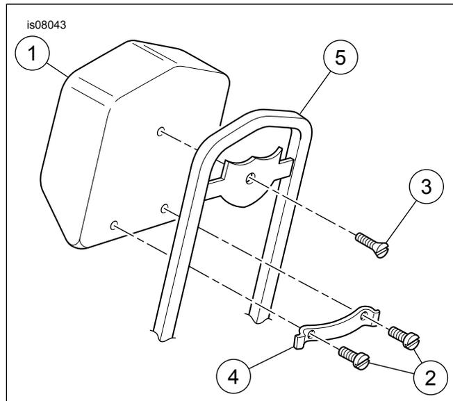
Figura 1. Conjunto del respaldo, vista ampliada
