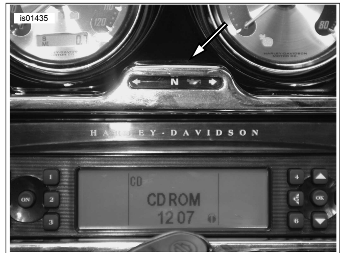
Afbeelding 1. Indicatielampjes correct uitgelijnd door de sierring heen
