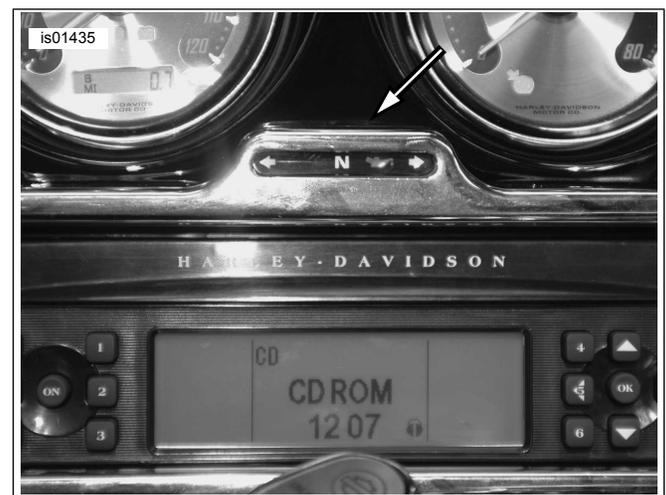
Figure 1. Indicateurs lumineux bien alignés à travers la plaque de fixation
