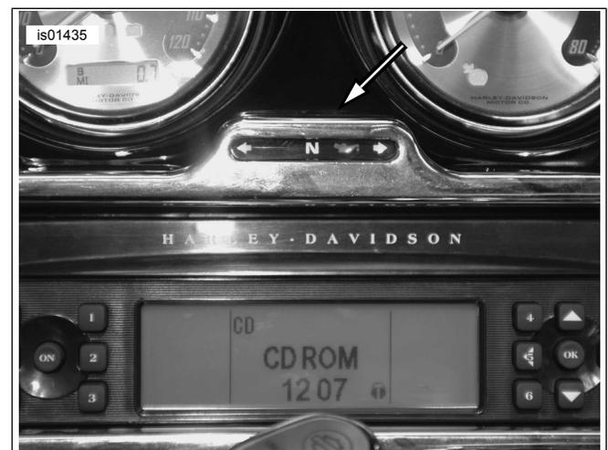
Abbildung 1. Blinkerkontrollleuchten durch Deckplatte richtig ausgerichtet
