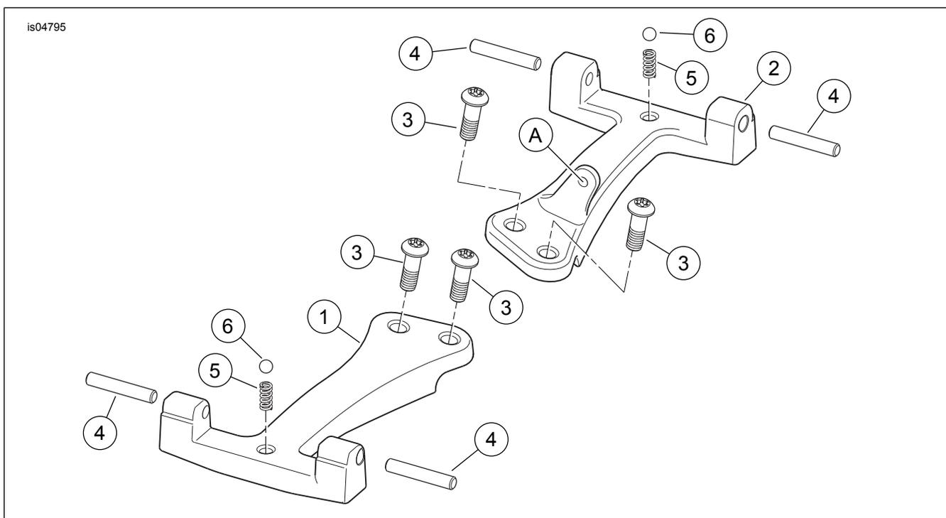
Figure 2. Pièces détachées : kit de support de marchepied de passager
