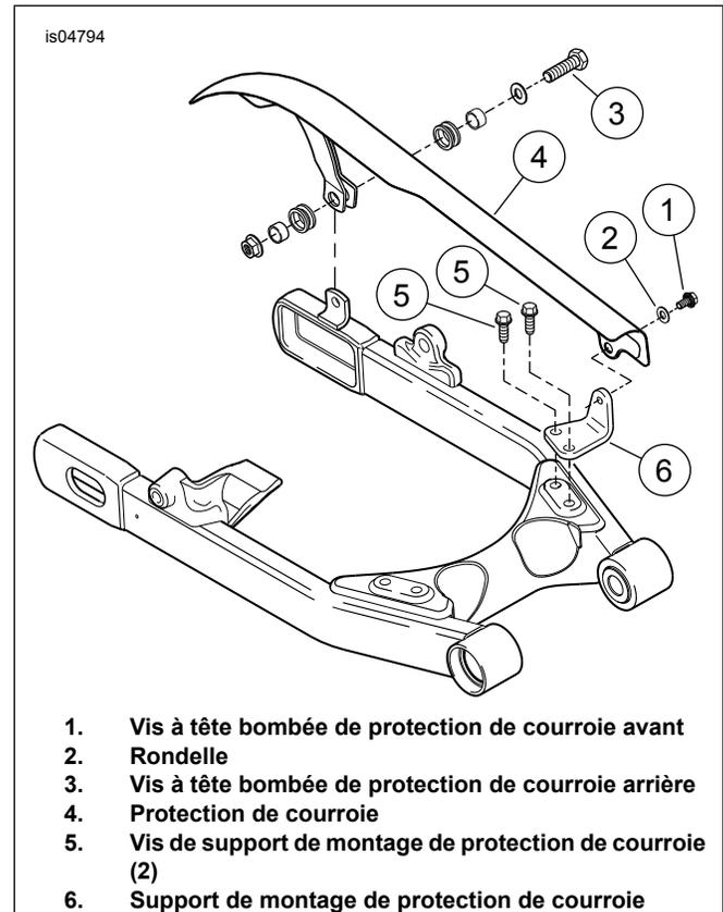
Figure 1. Composants de fixation de protection de courroie
