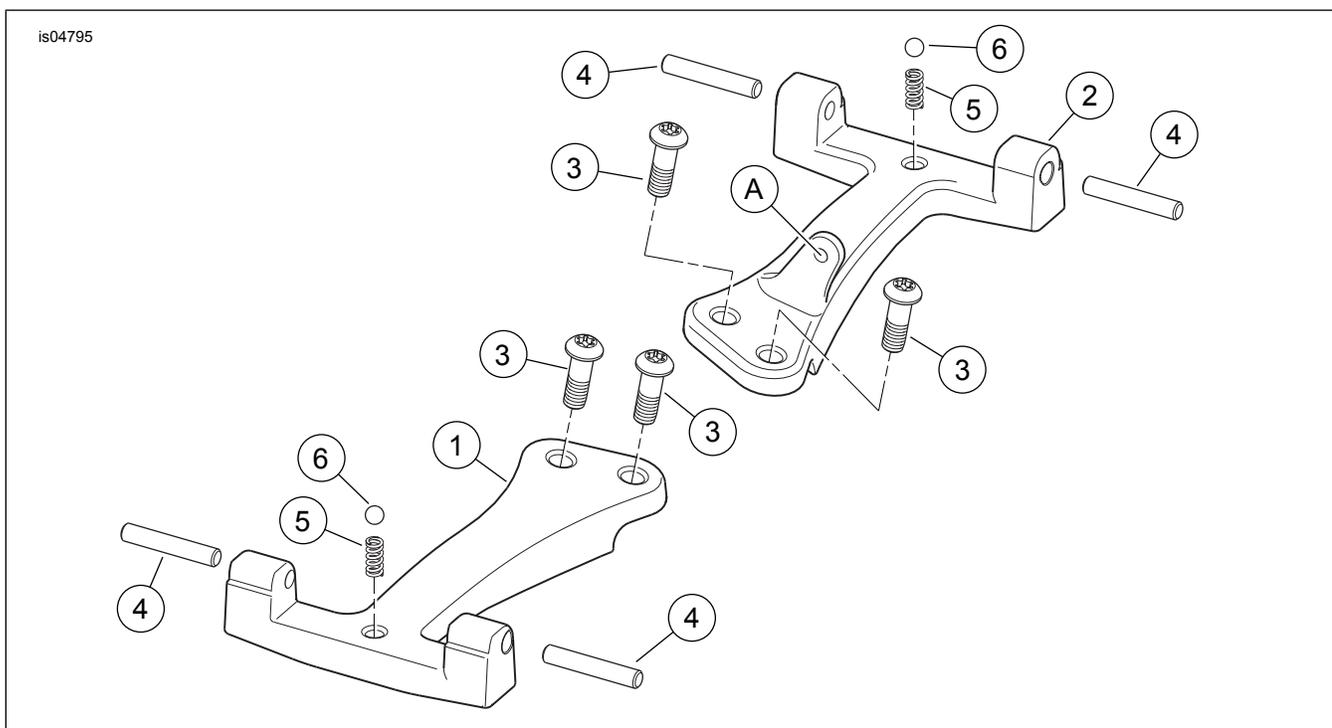
Figura 2. Parti di ricambio, kit sostegno della pedana del passeggero
