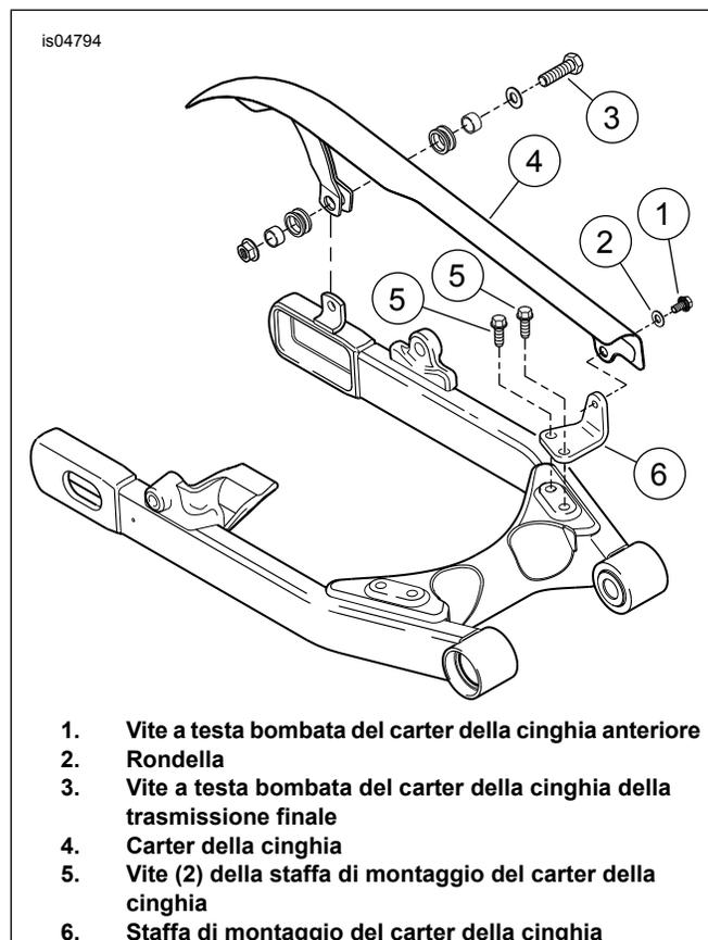
Figura 1. Componenti di fissaggio del carter della cinghia
