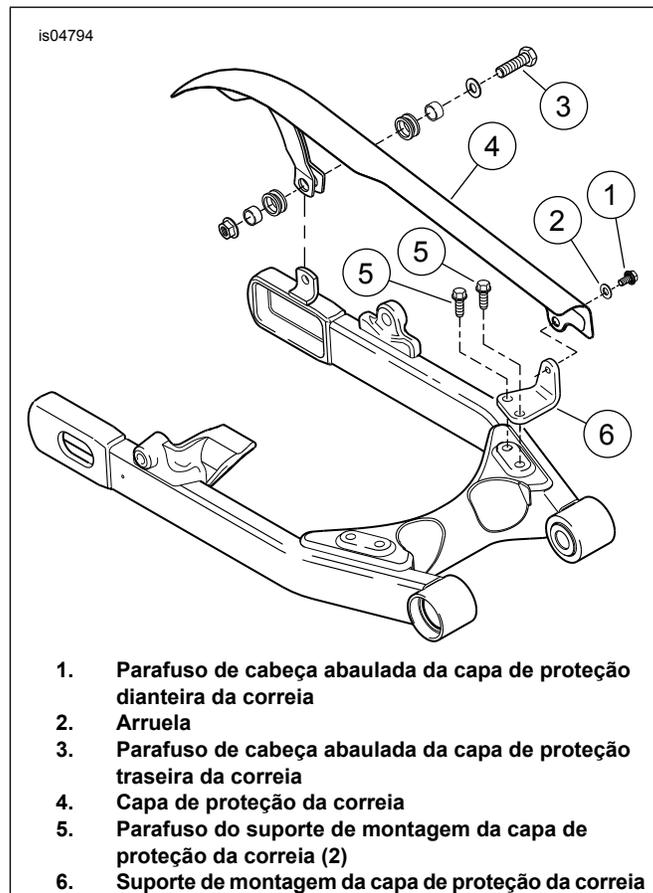
Figura 1. Componentes de fixação da capa de proteção da correia
