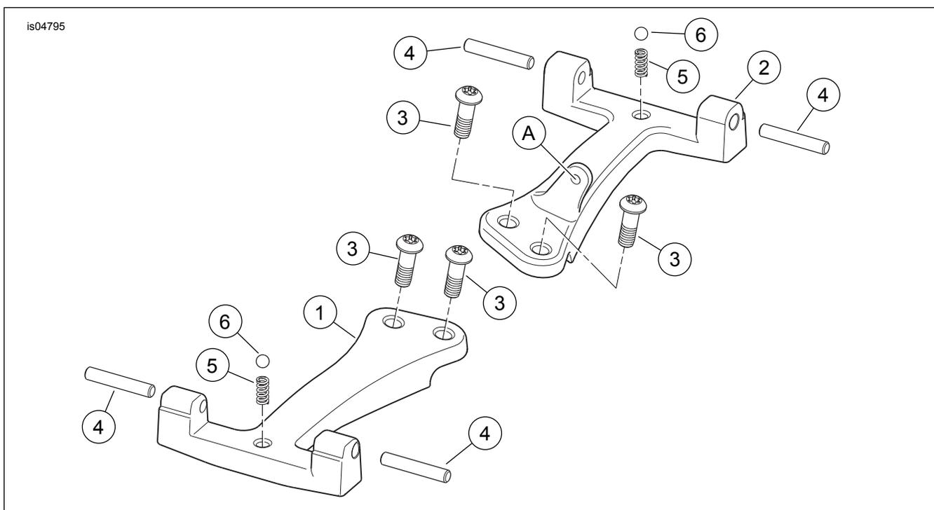
Figura 2. Peças de reposição, kit de suporte do estribo do passageiro
