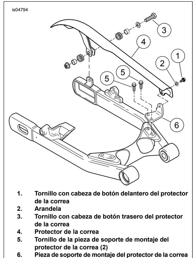
Figura 1. Componentes de sujeción del protector de la correa
