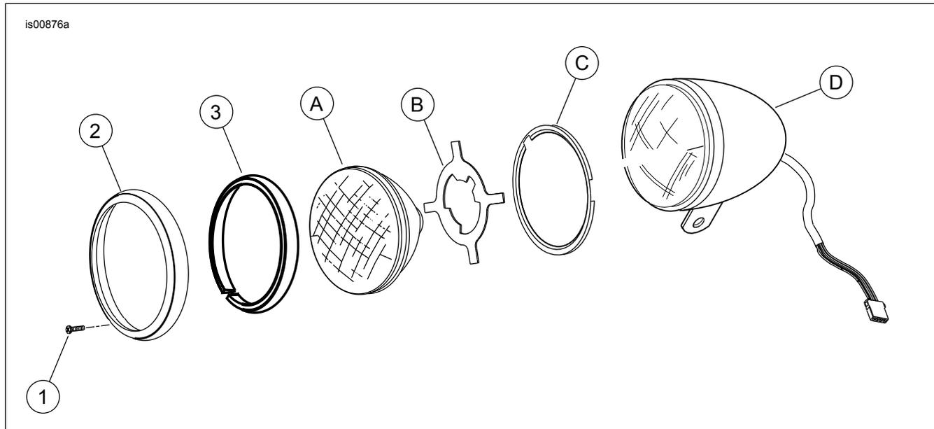
Figura 2. Parti di ricambio: anello di rivestimento del faro anteriore
