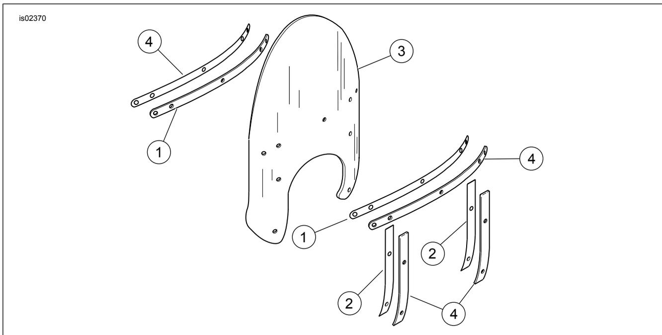
Figura 1. Parti di ricambio: Kit parabrezza
