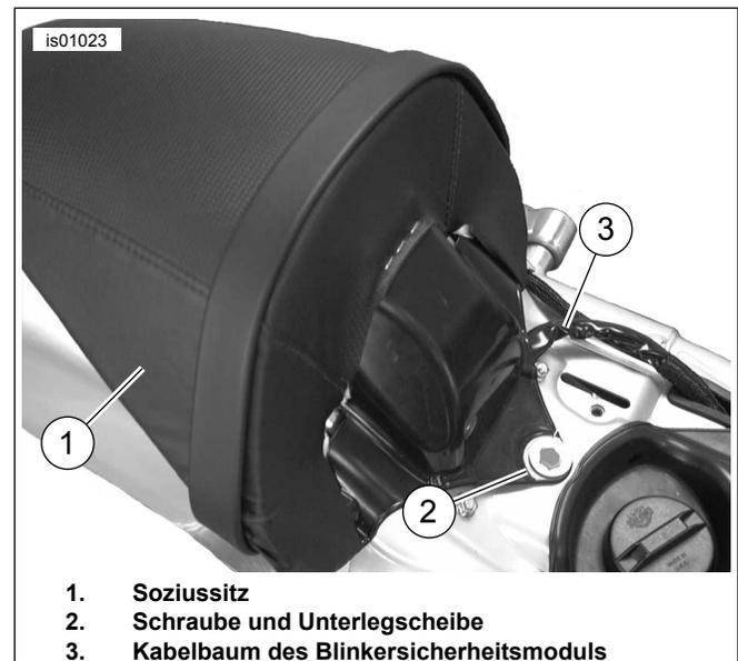
Abbildung 2. Ausbau der Soziussitz-Befestigungsschraube mit Unterlegscheibe
