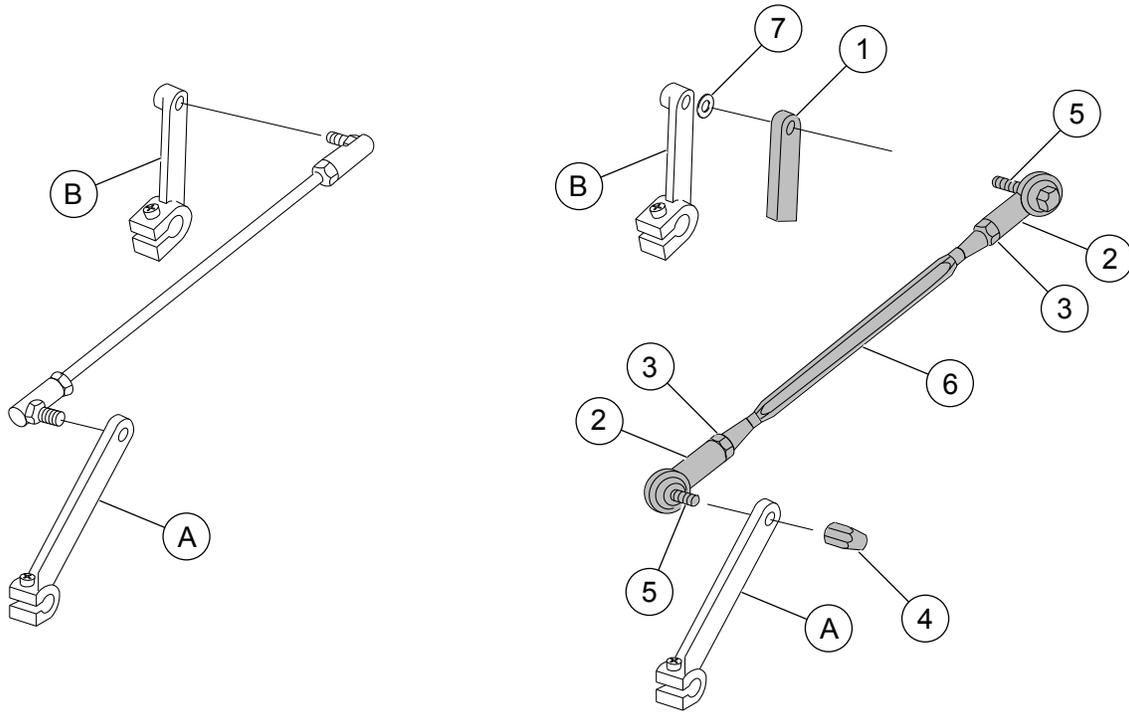
Abbildung 1. Ersatzteile: Schaltgestänge, Dyna
