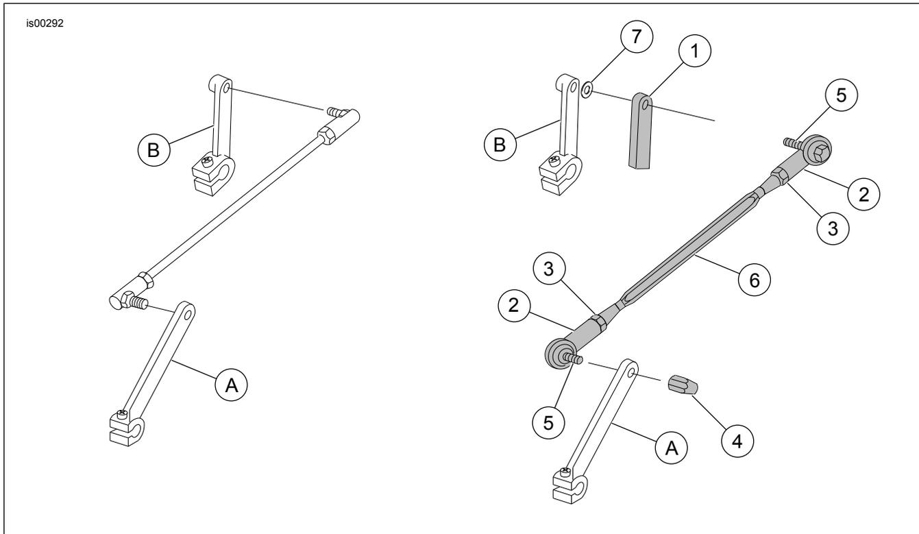
Figura 1. Parti di ricambio: leveraggi del selettore delle marce dei modelli Dyna
