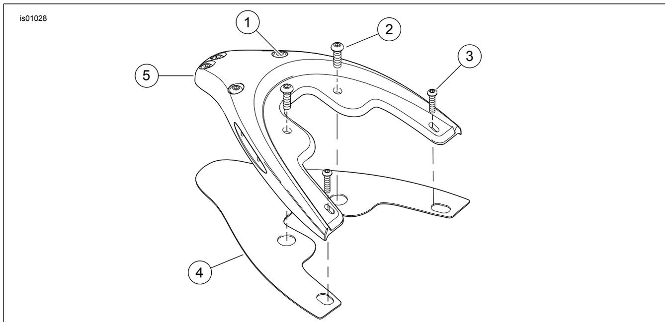
**Figura 7. Peças de reposição: kit da chapa de suporte**
