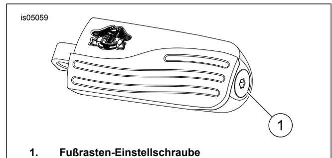
Abbildung 1. Fußrasten-Einstellschraube
