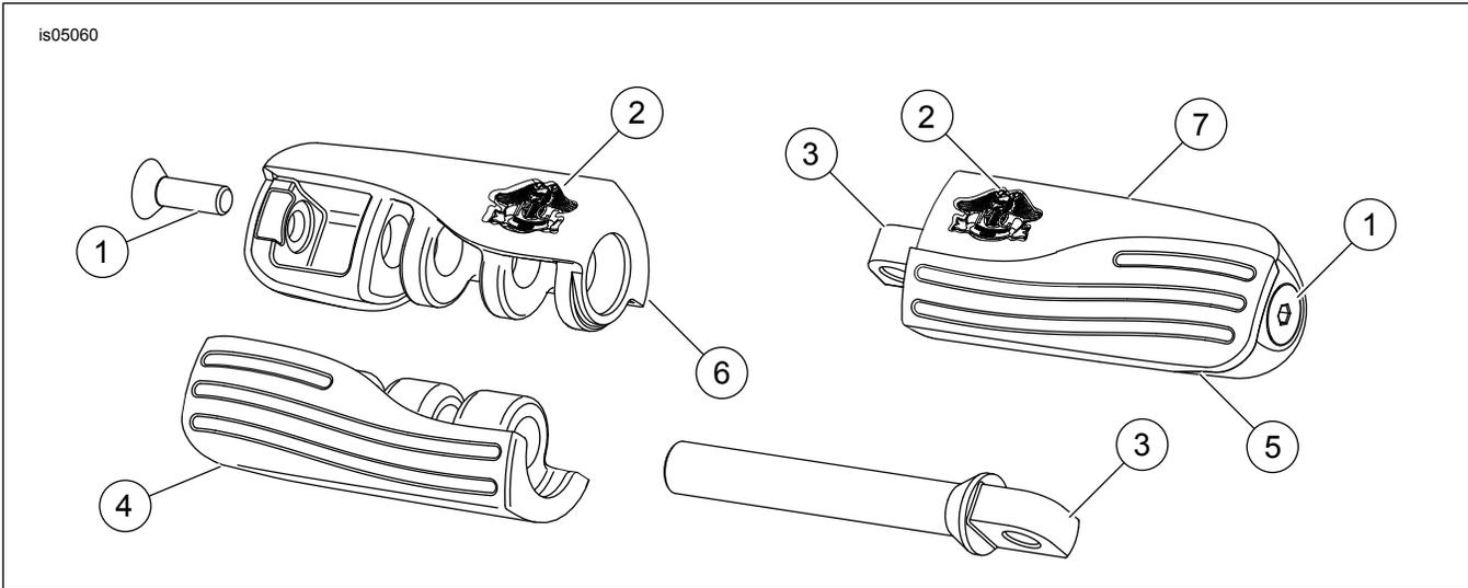
Abbildung 3. Ersatzteile: Fussrastensatz „HOG“
