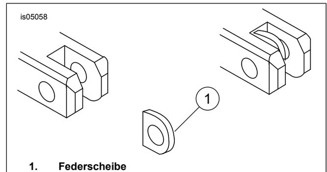
Abbildung 2. Fußrasten-Federscheibe einbauen
