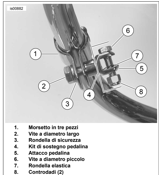
Figura 1. Installazione del kit attacco pedalina (pedalina non illustrata)
