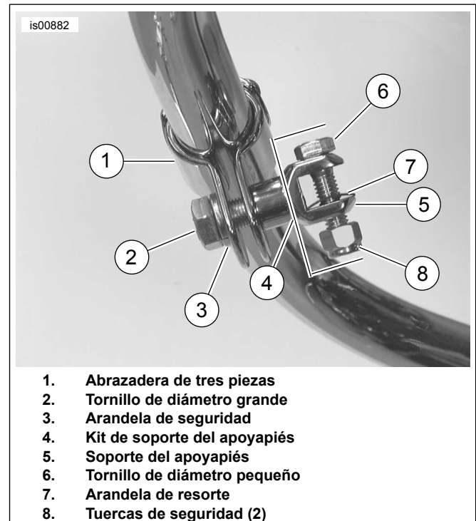
Figura 1. Instalación del kit de montaje del apoyapiés (no se muestra el apoyapiés)
