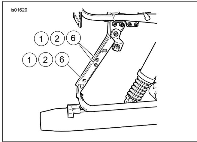
Figura 5. Elementos de sujeción de tiras de relleno
