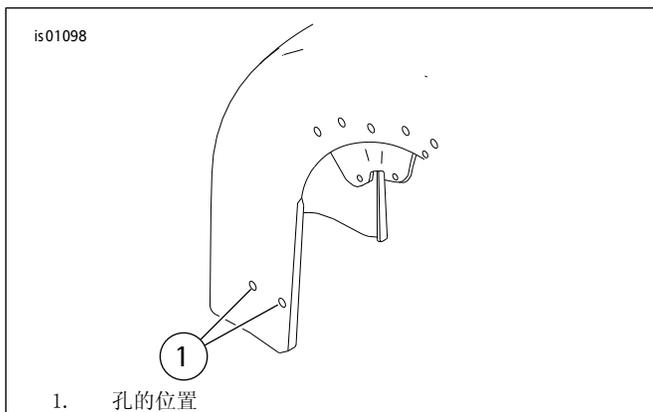
图2。安装清洁前挡板裙板
