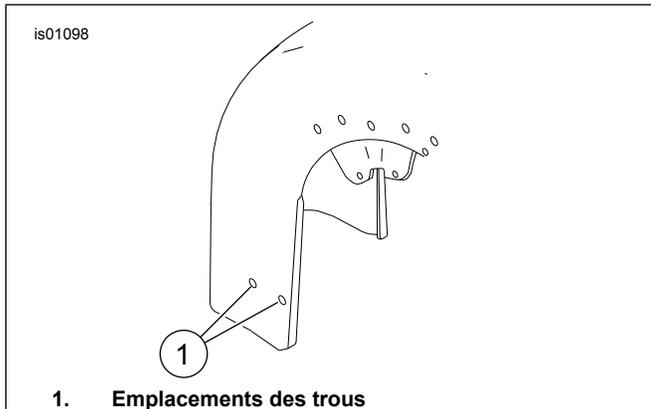
**Figure 2. Installation de la jupe de garde-boue avant dénudé**
