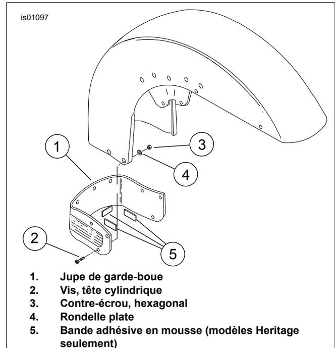
Figure 1. Jupe de garde-boue avant et visserie d'assemblage
