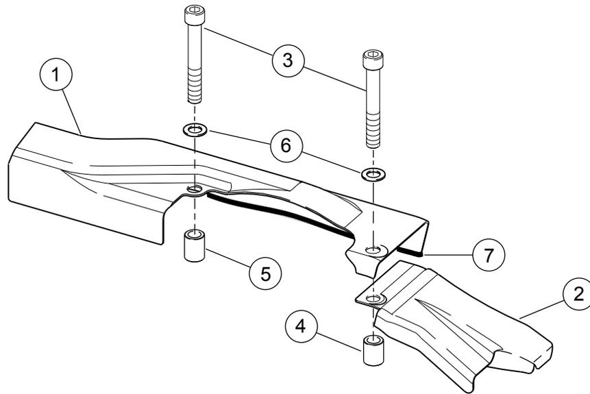
Figure 3. Pièces détachées : kit de couvercle de tuyau de reniflard
