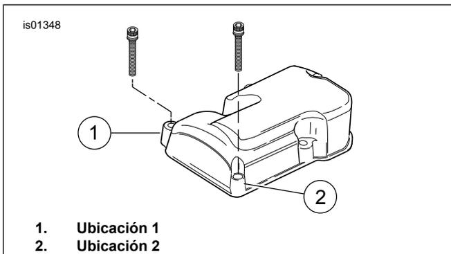
**Figura 2. Extracción de los tornillos**
