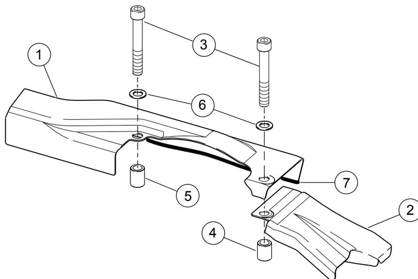
**Figura 3. Piezas de servicio: kit de cubierta para la manguera del respiradero**
