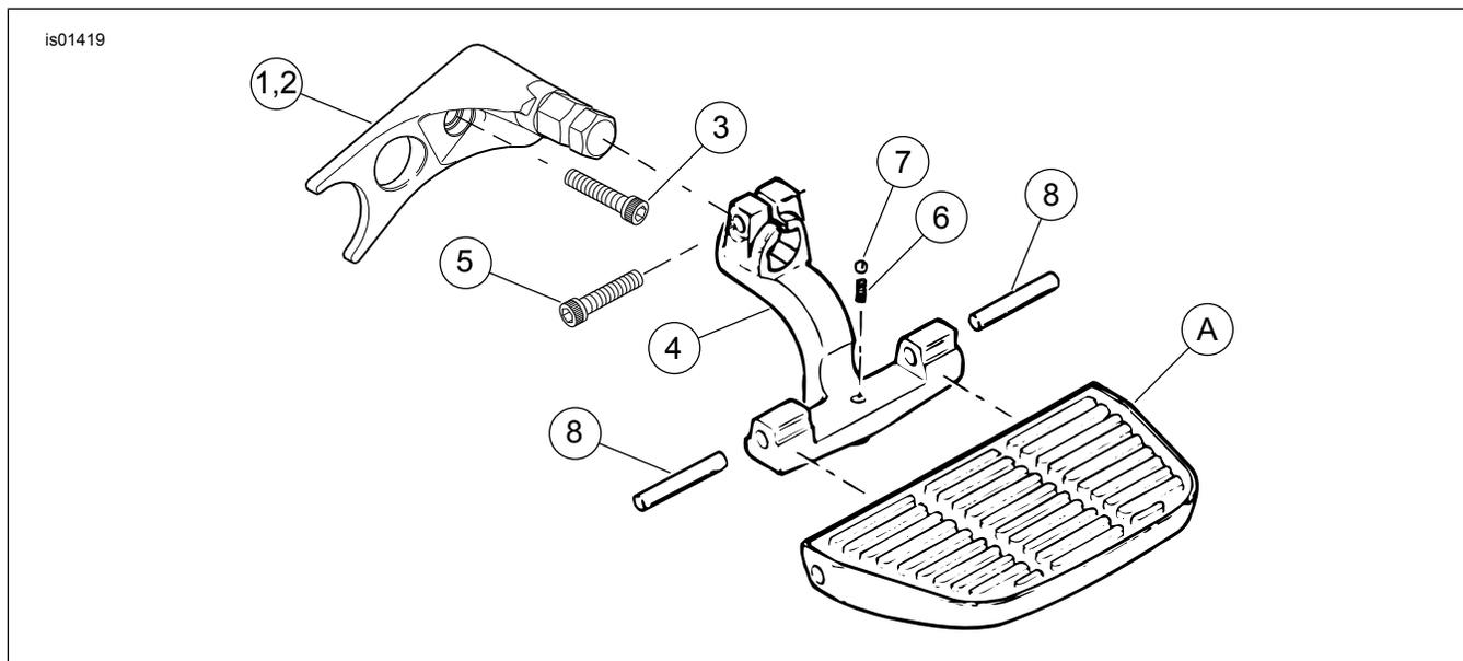
Figura 1. Parti di ricambio: Kit sostegno della pedana del passeggero Softail
