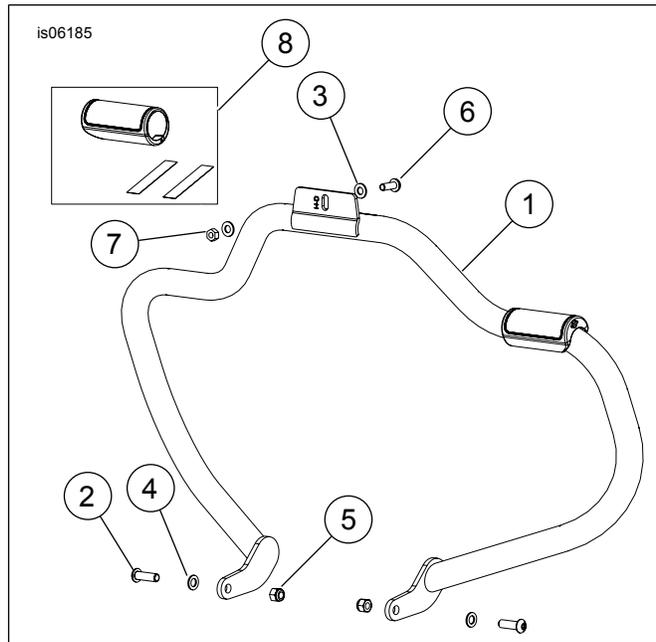
Figura 4. Piezas de servicio: Protector del motor Mustache
