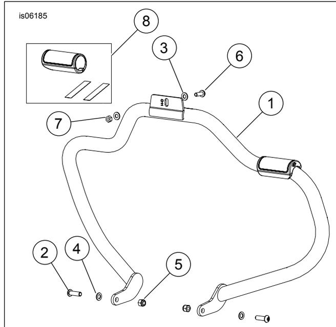
Abbildung 4. Ersatzteile: Mustache-Motorschutzbügel
