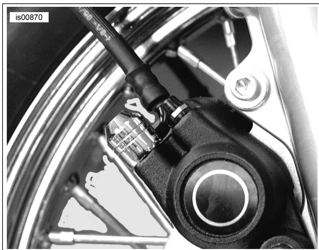
Abbildung 3. Einbau der Hohlschraubenabdeckung
