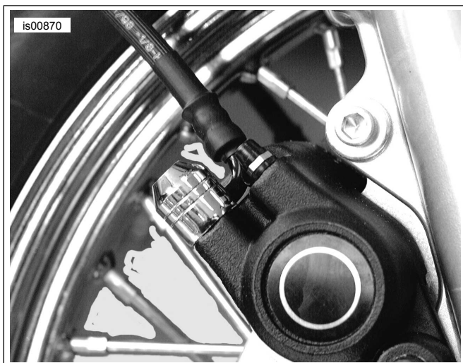
Figura 3. Coperchio del bullone passante installato
