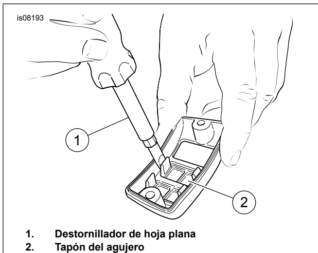
Figura 6. Extracción/reubicación del (los) tapón(es) del agujero
