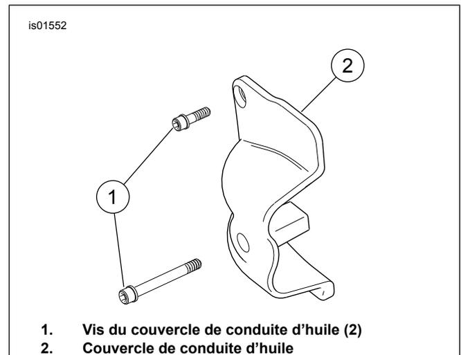
Figure 2. Dépose du couvercle d'huile
