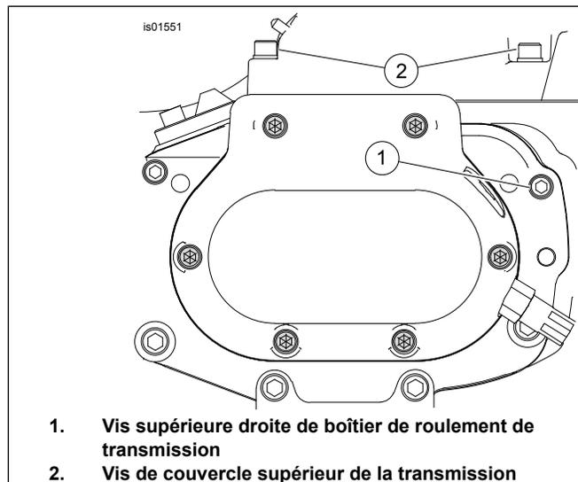
Figure 1. Emplacement d'installation du support de montage
