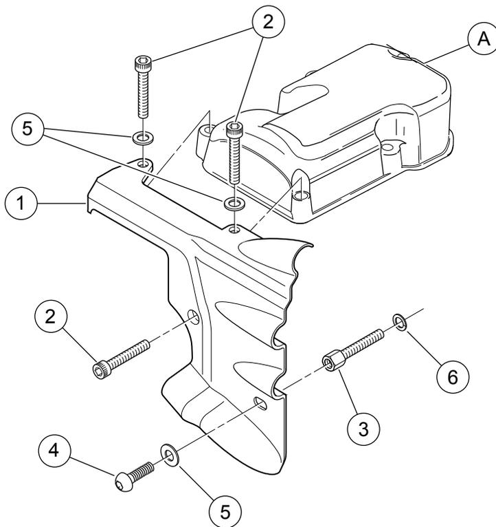
**Figura 3. Parti di ricambio: coperchio interfaccia cambio/motore**
