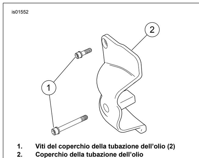
Figura 2. Rimozione del coperchio dell'olio
